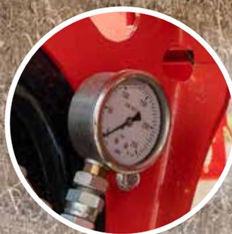
Манометр гидравлической системы турбины.
