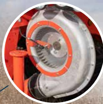
Турбина с гидравлическим приводом, заключенная в алюминиевый корпус.
