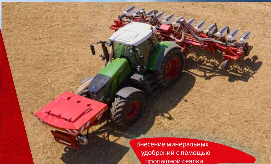
Внесение минеральных удобрений с помощью пропашной сеялки.
