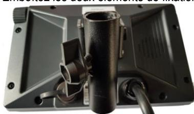
4. Introduisez la tige filetée de la poignée de serrage au travers du support ainsi assemblé :
