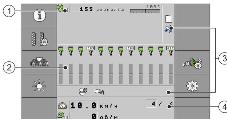
Рабочий шаблон сеялки точного высева
