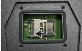
3. - Déverrouillez le support de la carte SIM en le poussant soigneusement dans le sens de la flèche.
