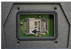
3. - Déverrouillez le support de la carte SIM en le poussant soigneusement dans le sens de la flèche.
