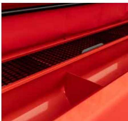
Interior de tolva combinada.
