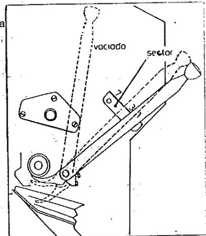
Se suelta el pomo del Variador, se desplaza el brazo-flecha sobre la placa numerada del 0 al 100 y se fija nuevamente sobre el número que previamente se habrá seleccionado.
