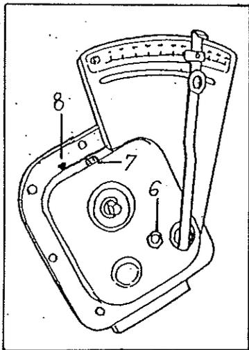
Controlar el nivel del VARIADOR a través de la mirilla (6) y si es necesario completar con aceite SAE-30 por el tapón (7).
