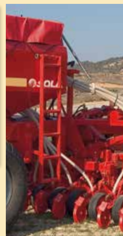
-ESCALIER DE SERVICE PORU MACHINES À 5 MÈTRES
